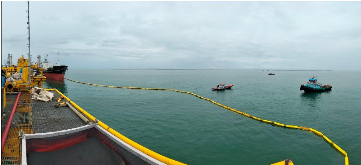
รูป: ทู่นกักคราบน้ำมัน (Oil Containment Boom)
