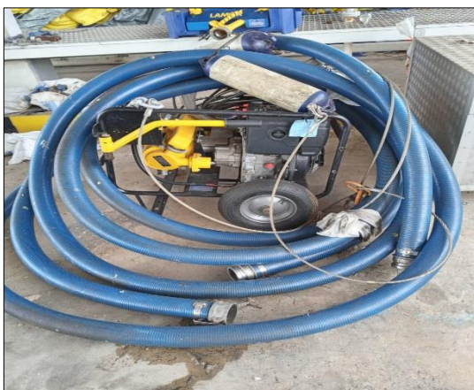
รูป: เครื่องเก็บคราบน้ำมัน (Oil Skimmer)
